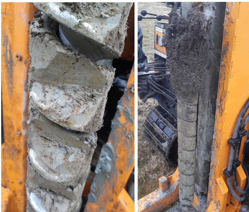
Figur 11. Foton från fältarbete 2022-04-04. Exemplifierande foto på torrskorpelera från punkt 22AF09 samt på jordlagerföljden 0-1 meter under markytan i punkt 22AF06.
