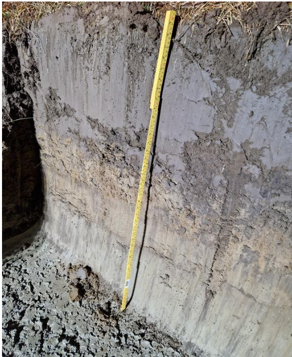
Figur 6a. Provgrop 2301 (0-1 m djup) med siltig och lerig humus på 0-0,45 m djup, sand på 0,45-0,75 m djup och ljusgrå lera på 0,75-1 m djup.
