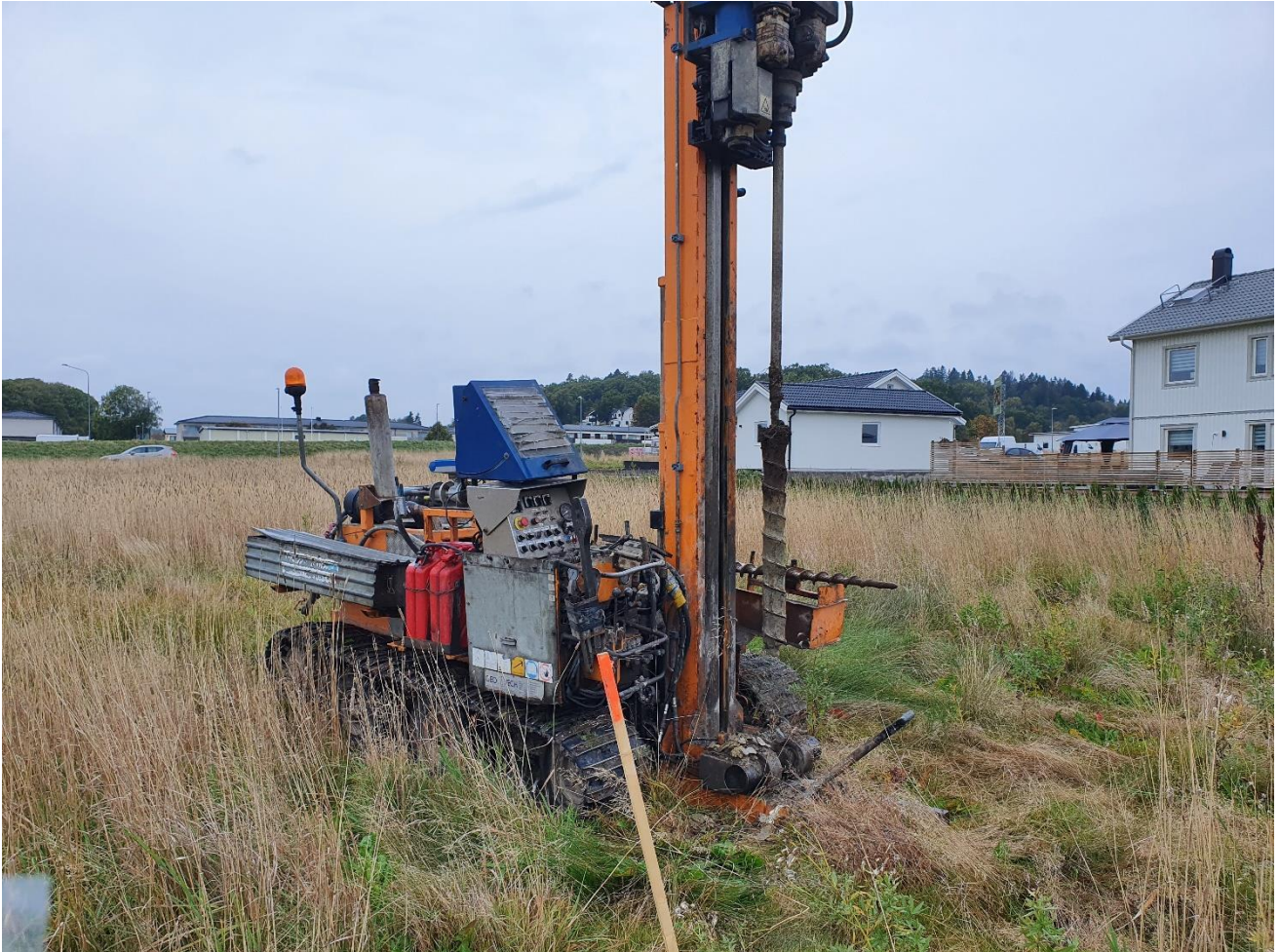
Figur 5. Jordprovtagningen utförd med borrbandvagn i punkt NC22A2.
