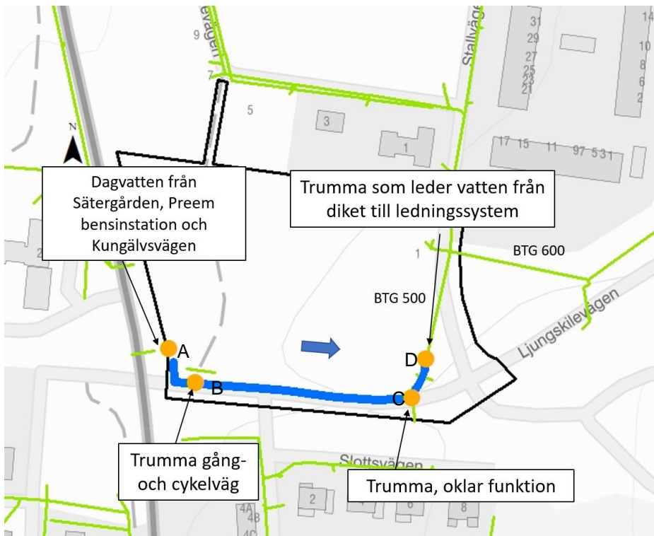
Figur 7. Placering av befintliga trummor i området framgår av orangea cirklar. Dimension för berörda dagvattenledningar framgår av svarta siffror.
